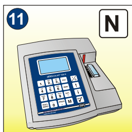
blank measurement zéro mesure cero medición
